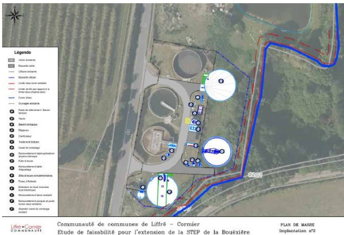
Figure 24 : Projet d'agrandissement de doublement de la capacité de la station d'épuration de la Bouëxière Extrait du dossier de Déclaration au titre de la Loi sur l'Eau
