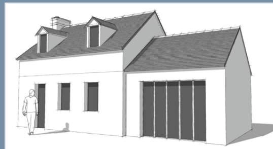
Exemple d'insertion d'une baie vitrée sur un volume secondaire
