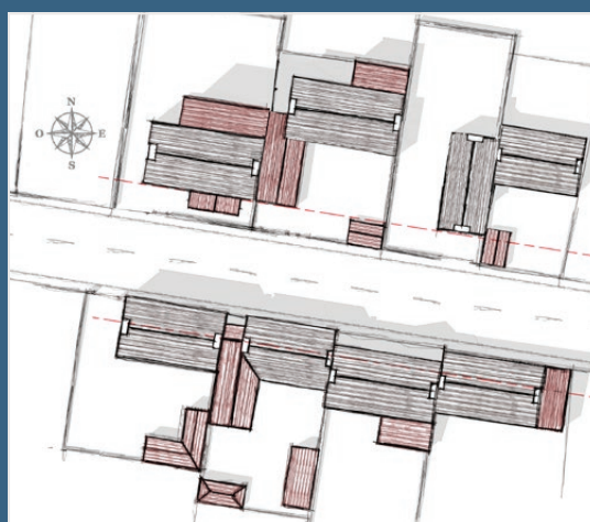
Implantations différentes sur les parcelles de la rive sud et de la rive nord d'une rue
