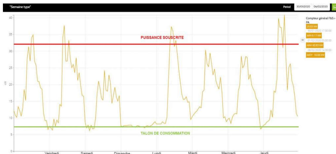
Pour garantir que la totalité de la production photovoltaïque sera autoconsommée, il est prévu un dispositif de supervision et de régulation temps réel de la production en fonction de la consommation.
