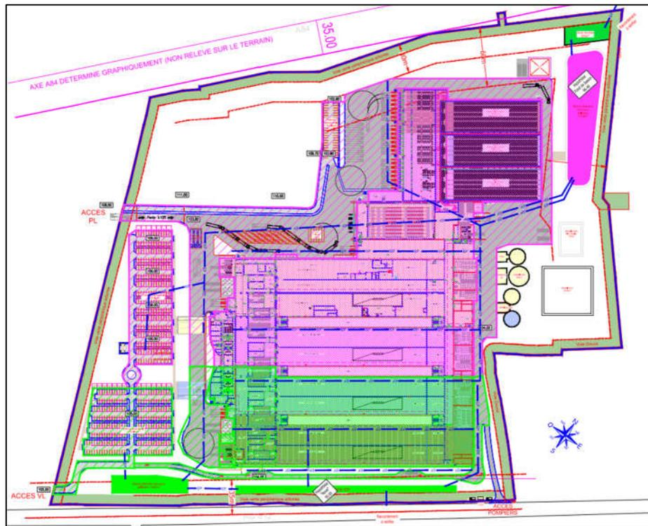
**Figure 2 : Schéma de la répartition de la gestion des eaux pluviales par bassin versant (Nord/Sud) – version Novembre 2021**
