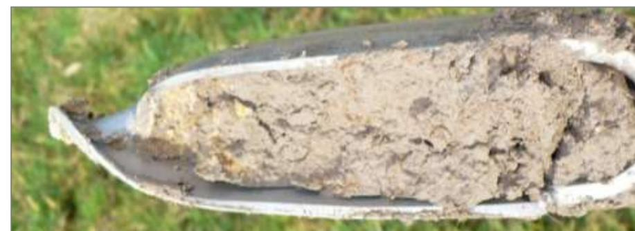
**Sondage 3 : classe V selon le GEPPA. Apparition de traits oxydo-réductiques dans les 25 premiers centimètres du sol, et intensification en profondeur. Régulièrement, blocage de la tarière entre 40 et 50 cm.**
