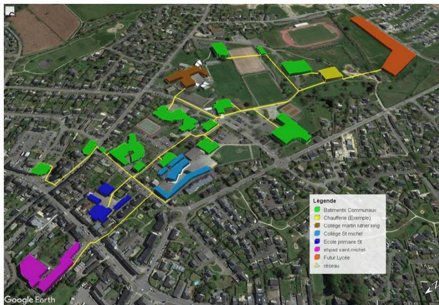
Source SDE de la ville de Liffré, illustration des raccordements du scénario 4 mix 80% bois 20% gaz.
